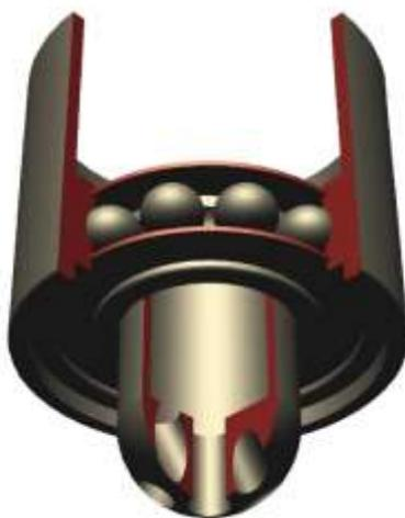
Рисунок 3.10 – Вращающаяся головка распыления
