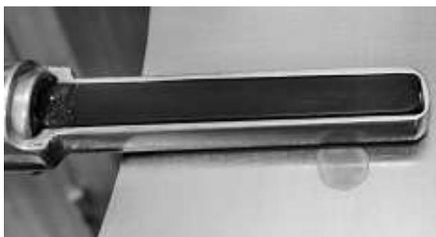
Рисунок 4.4 – Измерение магнитного поля пластины «малым» зондом ИМИ-3
