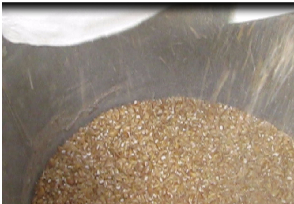
Рисунок 3.21 – Процесс движения измельченного пророщенного зерна из дробильной камеры в накопительную емкость
