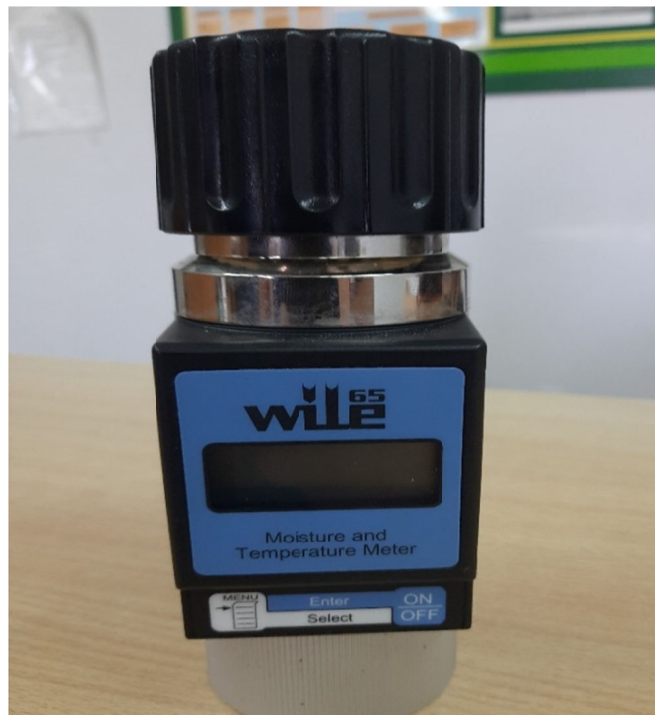
Рисунок 4.3 - Влагомер Wile 65 с помещенной массой пророщенного высушенного измельченного зерна
