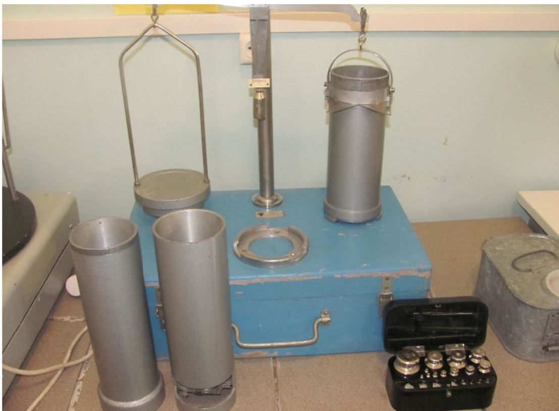
Рисунок 3.6 – Определение насыпной плотности измельчённой массы
