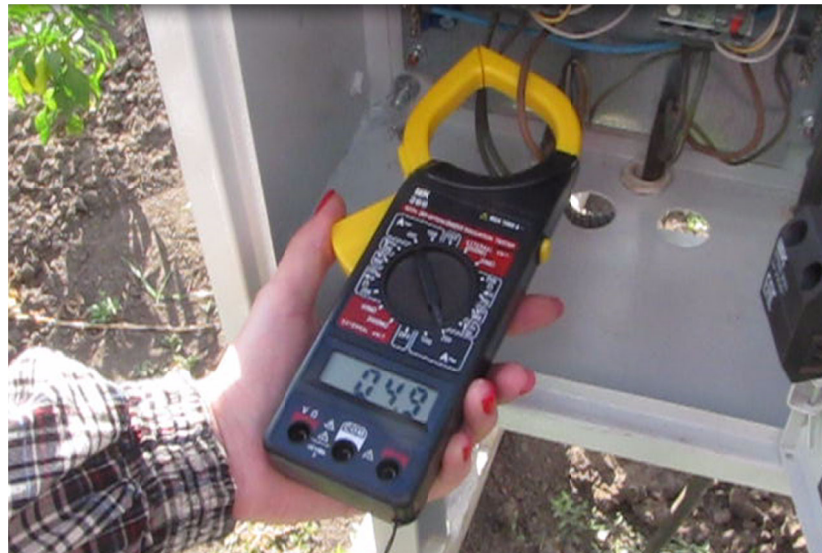
Рисунок 4.1 – Измерение силы тока
