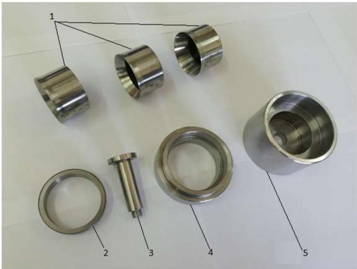
1 – калибр-резец; 2 – втулка-образец; 3 – ось; 4 – корпус центрирующего приспособления; 5 – центрирующая оправка
