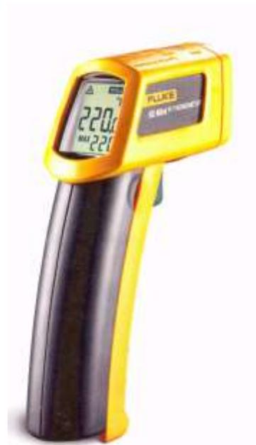
Рисунок 3.20 – Инфракрасный пирометр «Fluke-62»
