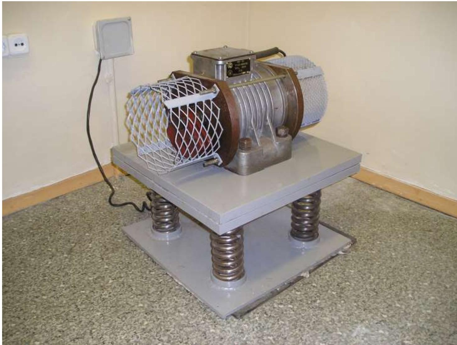
Рисунок 3.19 – Стенд для испытания подшипниковых узлов при циклическом нагружении
