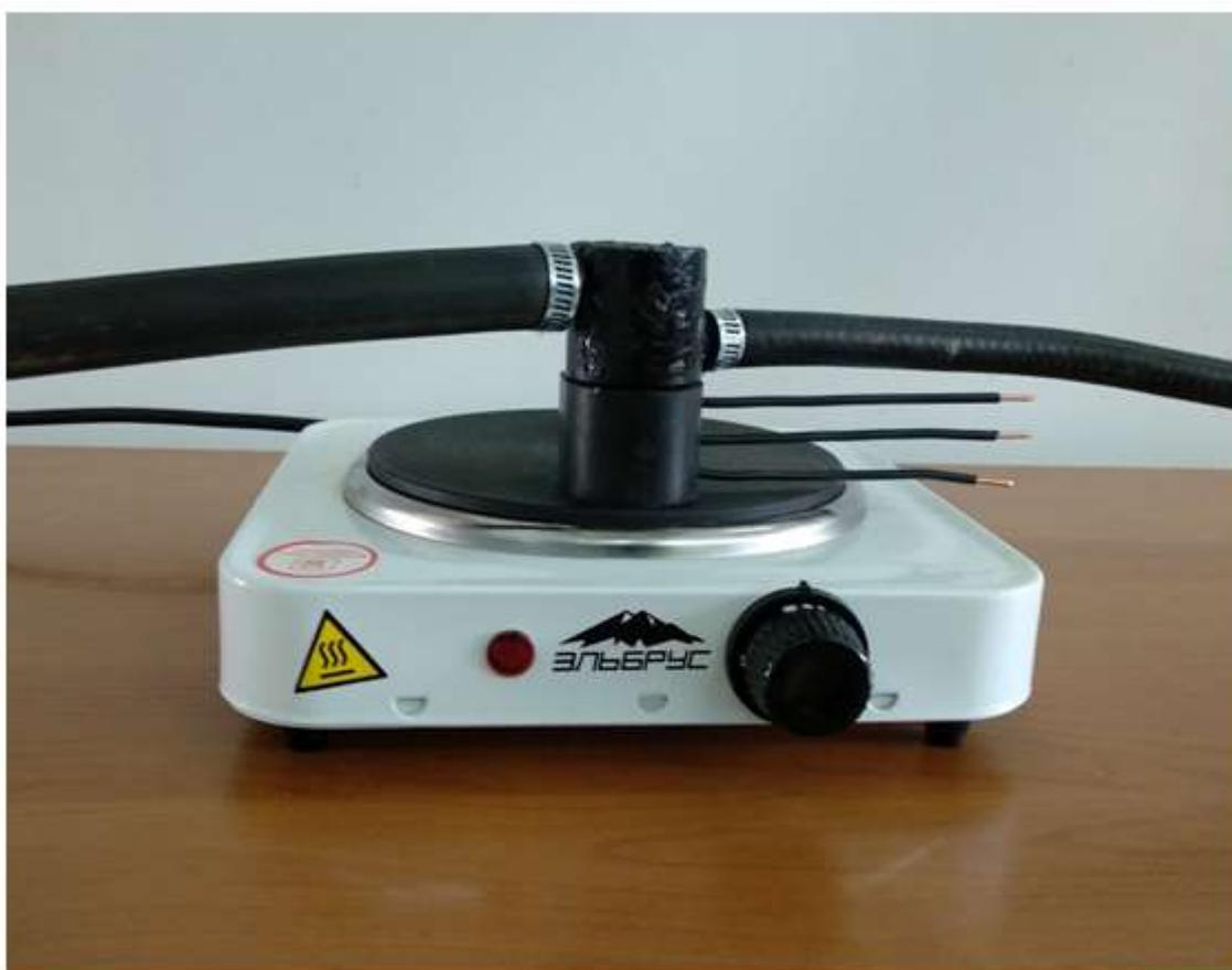
1 – холодильник; 2 – втулка резиновая в сборе с медными дисками и образцом; 3 – электрическая плита с терморегулятором
