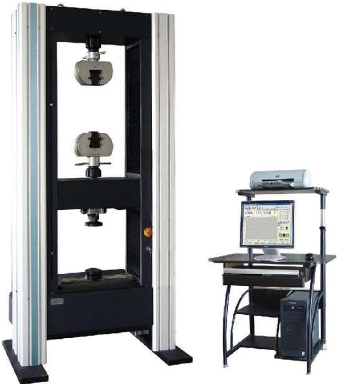
Рисунок 3.3 – Разрывная машина ИР 5082-50
