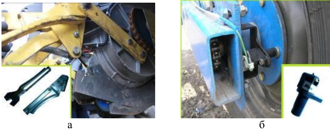
Рисунок 4.17 – Ёмкостный датчик высева (а) и индуктивный датчик пути (б)
