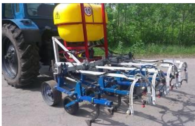
Рисунок 3.19 – Культиватор с аппликаторами для точной обработки посевов сахарной свеклы
