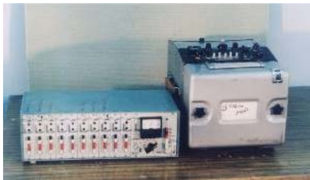
Рисунок 3.8 – Тензометрический усилителя «Топаз» и осциллограф К20-22
