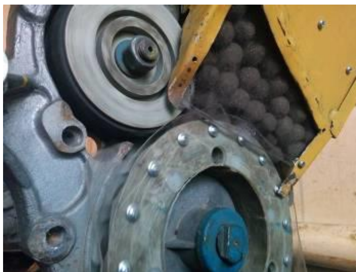
Рисунок 4.9 – Общий вид экспериментального высевающего аппарата, установленного на стенде
