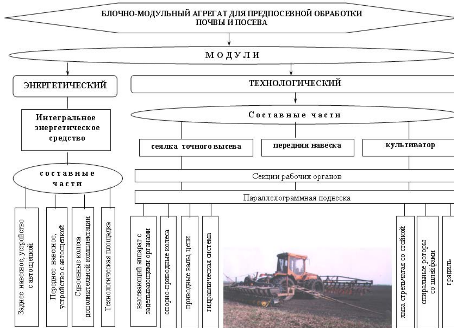
Рисунок 2.6 – Схема блочно-модульного агрегата для предпосевной обработки почвы и посева сахарной свеклы на базе интегрального энергетического средства.
