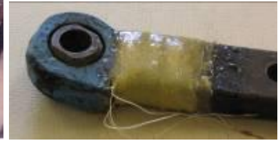
в) установка тензометрического датчика на тягу
