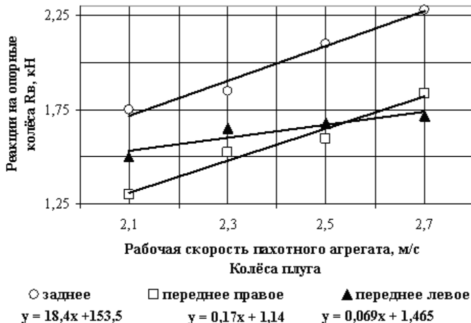
Рисунок 4.1 – Зависимость изменения вертикальных реакций на опорные колёса поворотного плуга от скорости движения пахотного агрегата
