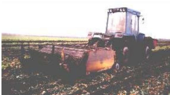
Рисунок 1.23 – Трактор ЛТЗ-155 в агрегате со свеклокопателем КВС-6
