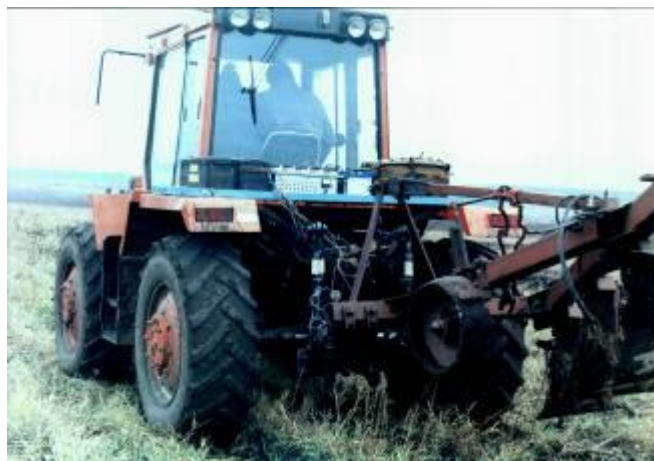
Рисунок 1.12 – Пахотный агрегат на базе трактора ЛТЗ-155 с классическим плугом
