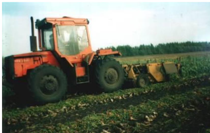
Рисунок 3.20 – Копатель-валкоукладчик КВС-6 в агрегате с трактором ЛТЗ-155
