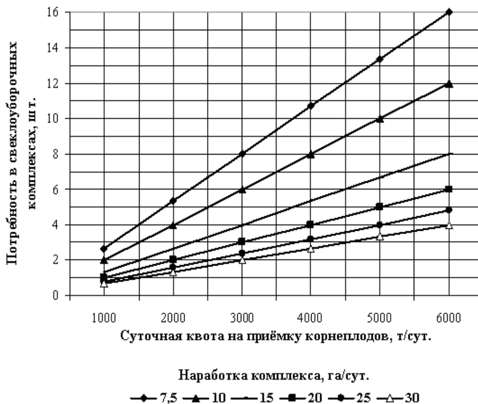
Рисунок 5.12 – Расчетная суточная потребность в свеклоуборочных комплексах при квотированной приёмке корнеплодов сахарным заводом (при урожайности корнеплодов 50 т/га)
