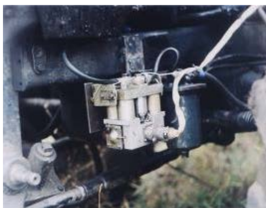
а) расходомер топлива, установленный на двигателе
