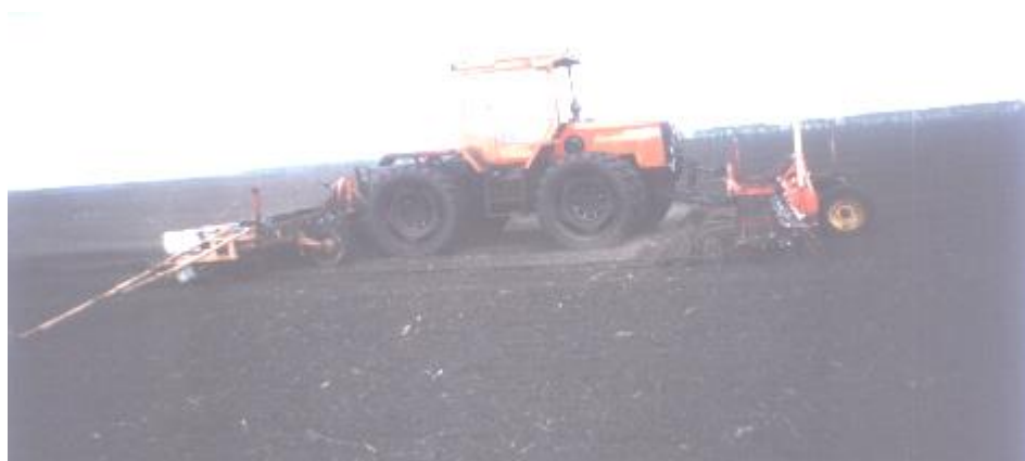
Рисунок 4.14 – Комбинированный блочно-модульный агрегат КРШ-8,1Г+НП-5,4А +ЛТЗ-155+СТВС-18 на посеве сахарной свеклы
