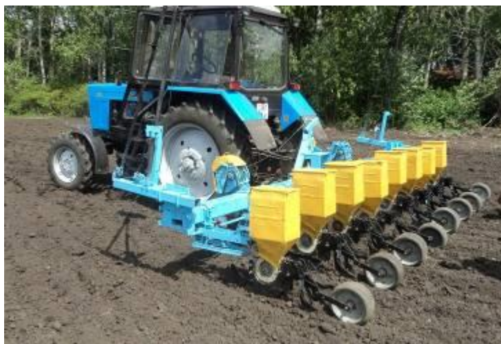
Рисунок 4.12 – Механическая сеялка для высева капсулированных семян
