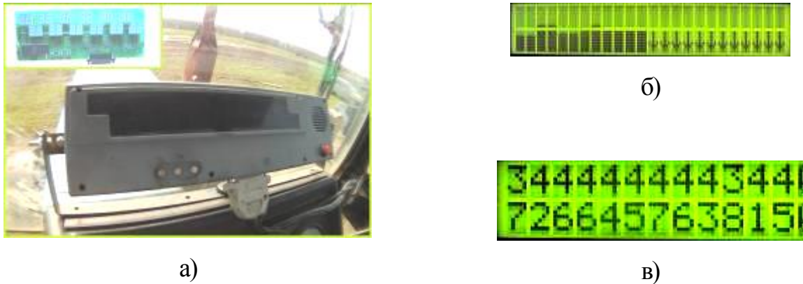
Рисунок 4.18 – Контроллер с показаниями на информационном табло (а) нормы высева семян в виде гистограммы (б) или цифрами (в)
