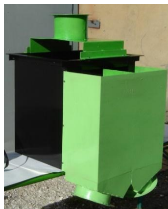
б) Двухканальный жалюзийный делитель с расходной характеристикой до 50 т/ч
