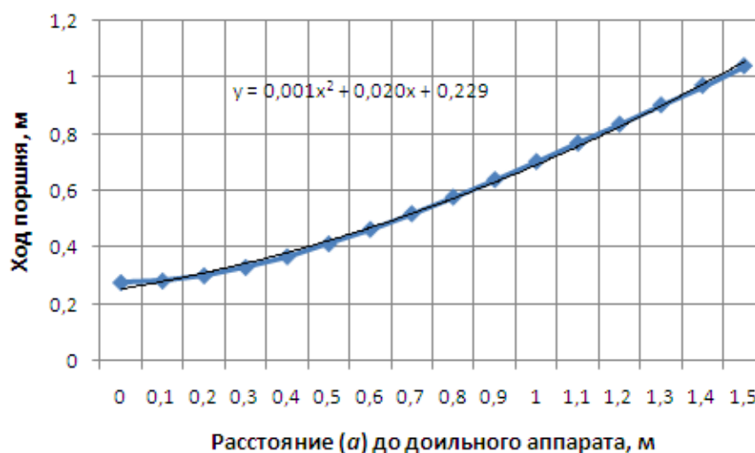
Рисунок 2.5 - График зависимости потребного хода поршня от расстояния от точки крепления троса к доильному аппарату до положения хвостовика в горизонтальной плоскости
