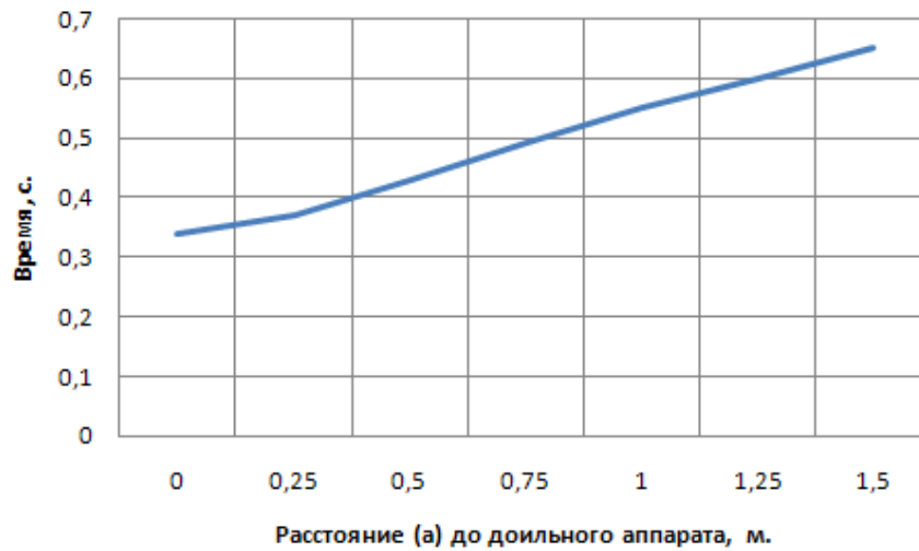
Рисунок 4.4 - Зависимость времени движения доильного аппарата с точки подвеса на вымени коровы в нижнюю точку траектории от его начального удаления (а) от мобильного агрегата
