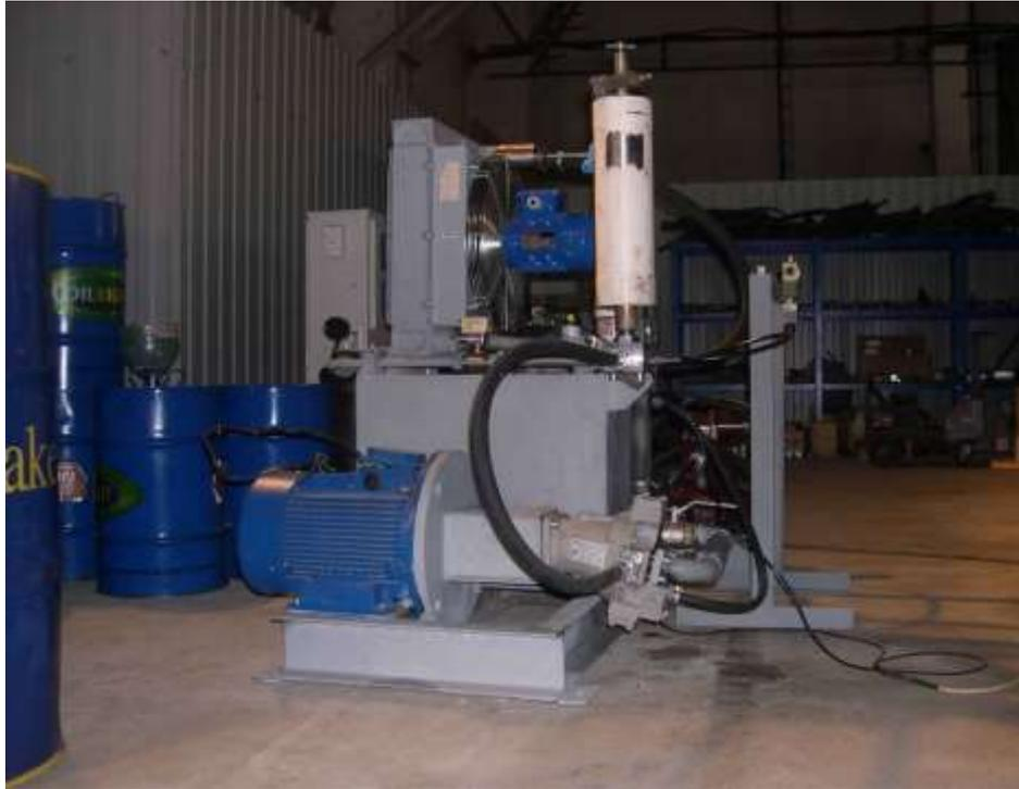
Рисунок 3.22 – Внешний вид гидростенда № ИГ032 для испытаний покрытий на герметичность
