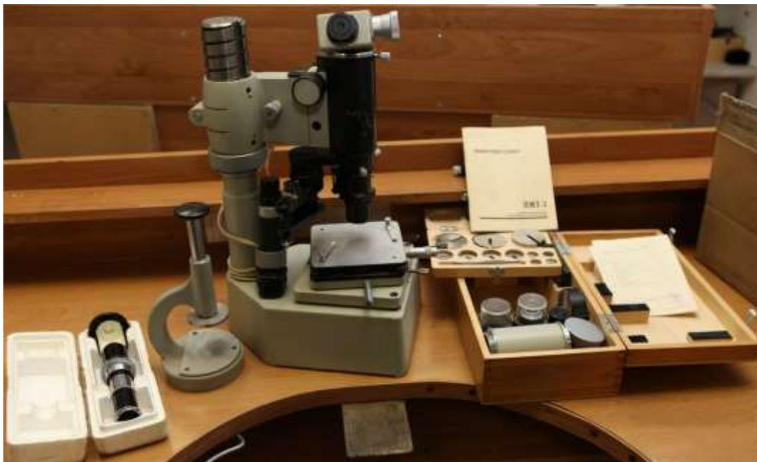
Рисунок 3.35 – Микротвердомер ПМТ-3
