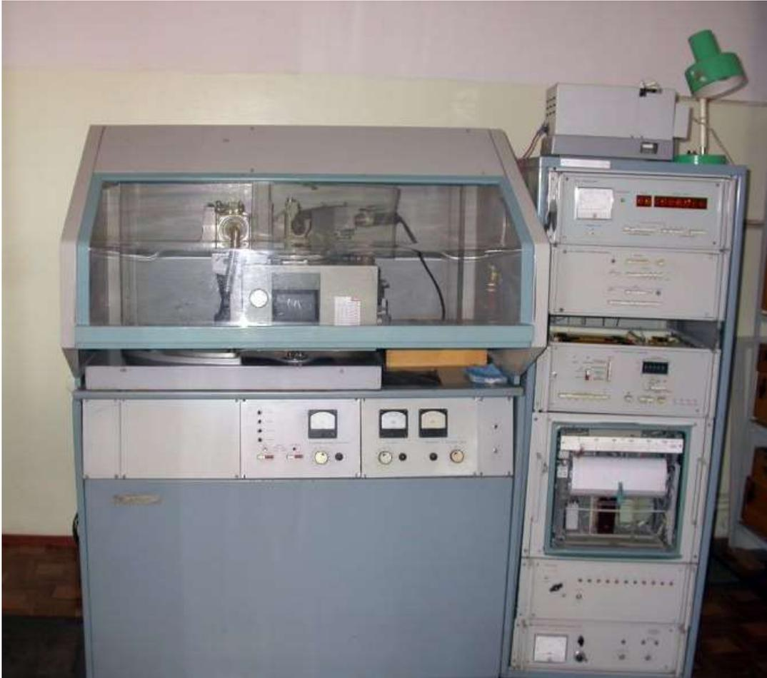
Рисунок 3.28 – Рентгеноструктурный дифрактометр ДРОН-3
