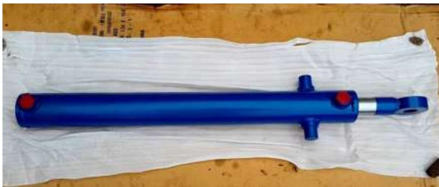
Рисунок 3.21 – Внешний вид гидроцилиндра МС80/50х710-3(4).32
