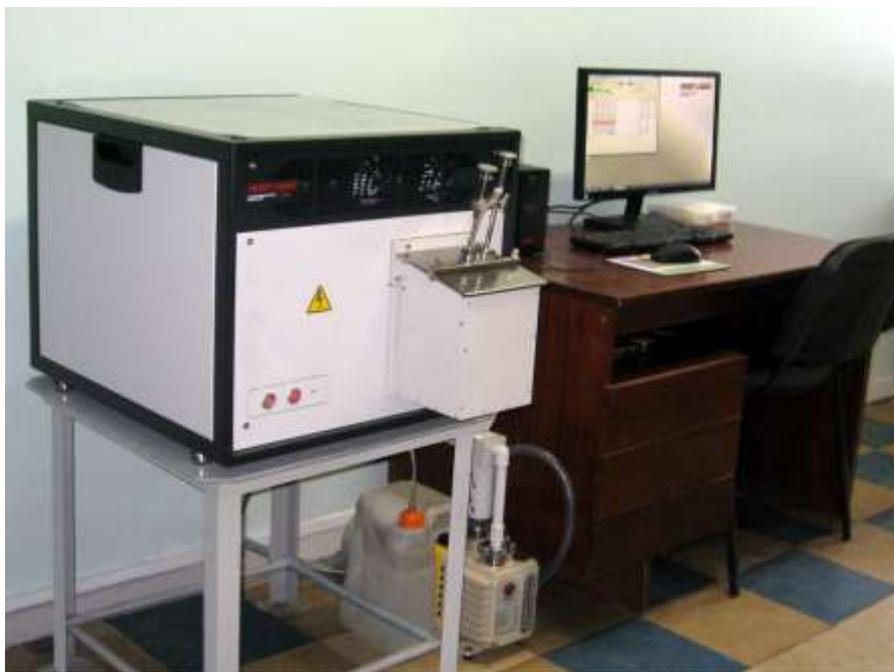
Рисунок 3.39 – Атомно-эмиссионный спектрометр «Искролайн-300»
