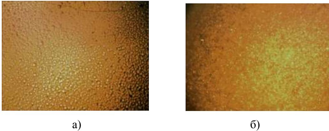
Рисунок 4.61 – Поверхности хромосодержащих покрытий (увеличение в 100 раз):
