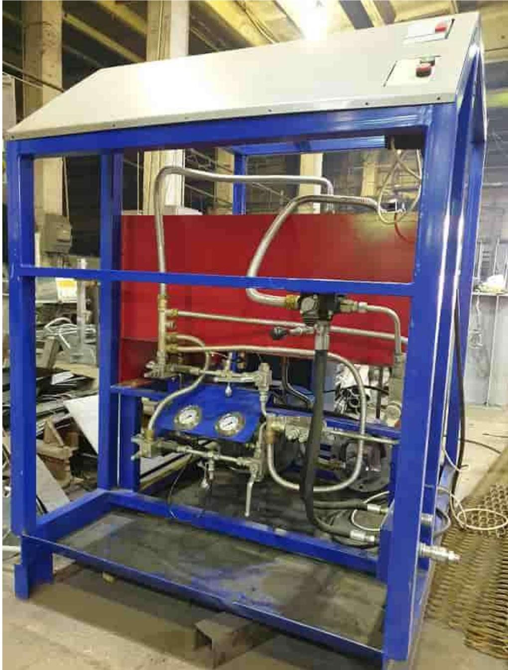
Рисунок 3.40 – Стенд для испытаний гидроцилиндров
