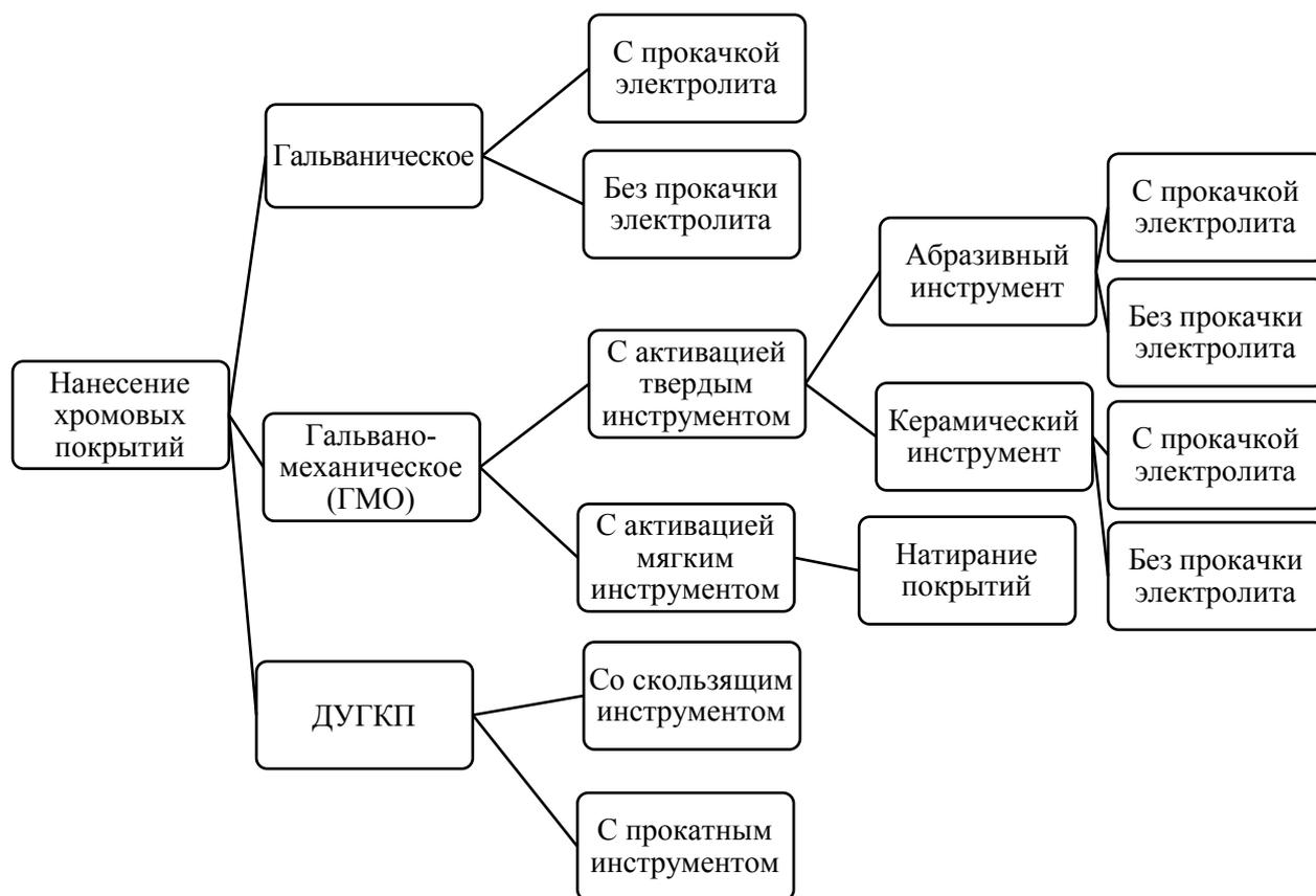
Рисунок 1.1 – Методы гальванического осаждения покрытий
