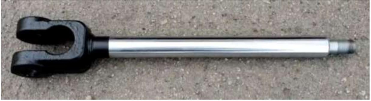
Рисунок 3.20 – Серийный шток для испытаний свойств покрытий
