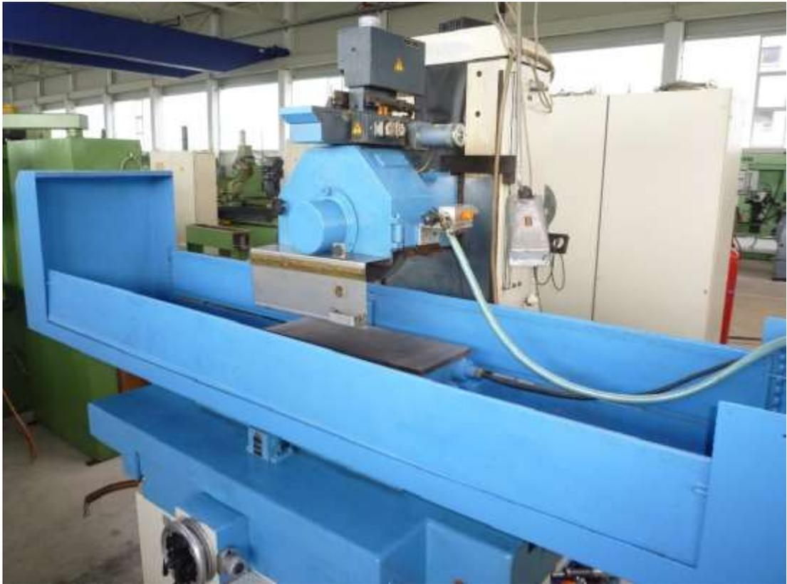
Рисунок 3.12 – Плоскошлифовальный станок с ЧПУ АВА-S-FPE-60-30
