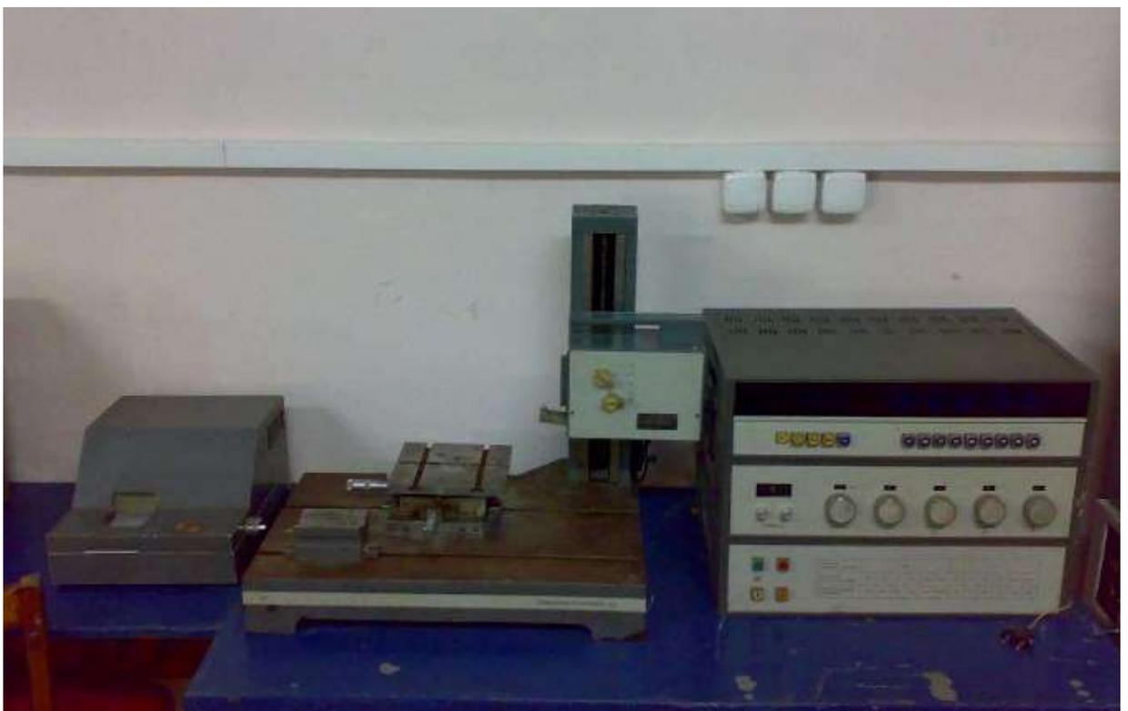
Рисунок 3.33 – Профилограф-профилометр мод. 252
