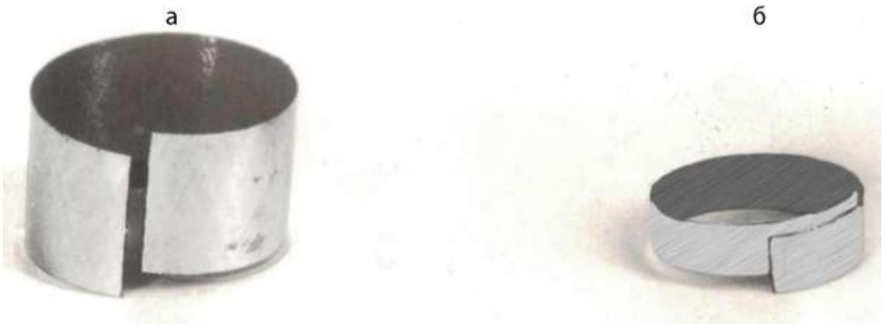
Рисунок 4.23 – Остаточные напряжения при нанесении стандартных и дисперсно-упрочненных композиционных покрытий
