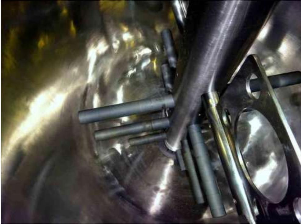
Рисунок 3.3 – Барабан атриторной мельницы
