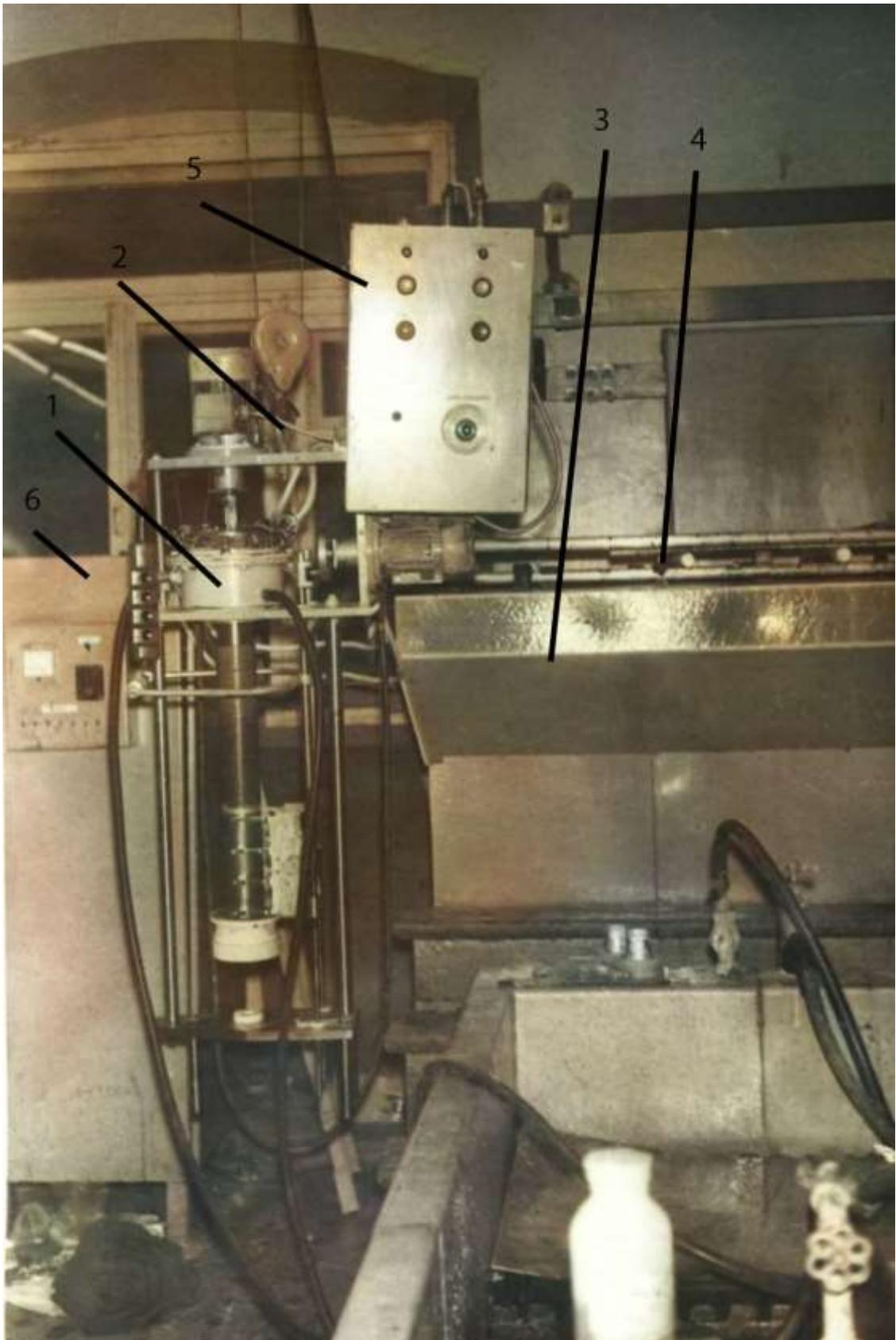
Рисунок 3.25 – Экспериментальная установка для нанесения композиционных дисперсно-упрочненных герметичных гальванических покрытий на основе хрома
