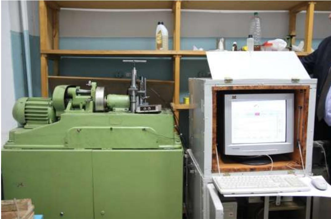
Рисунок 3.38 – Модернизированная машина трения МИ-1М
