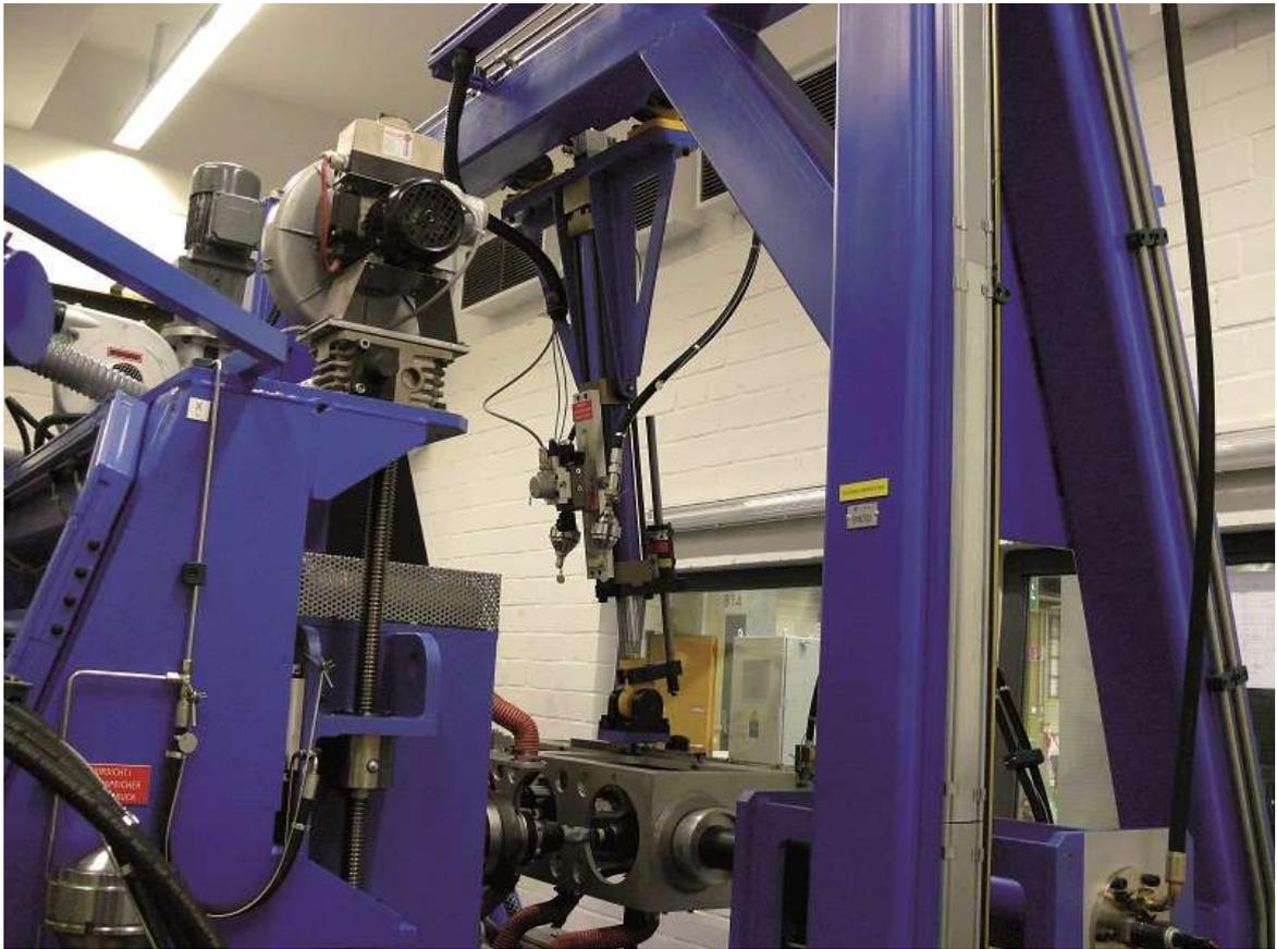
Рисунок 3.37 – Стенд для определения несущей способности
