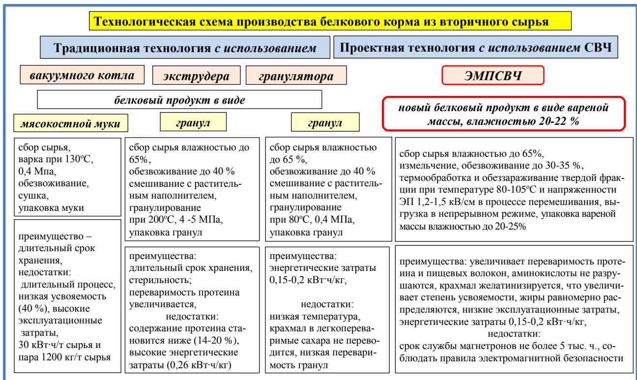
Рисунок 23 – Схема производства белкового корма из вторичного сырья традиционными и проектными вариантами
