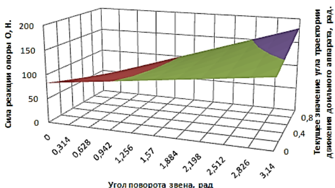
Рисунок 12. Зависимость реакции на опоре шасси O мобильного агрегата от текущего угла ( \alpha_t ) положения доильного аппарата на траектории движения и направления действия опрокидывающего момента
