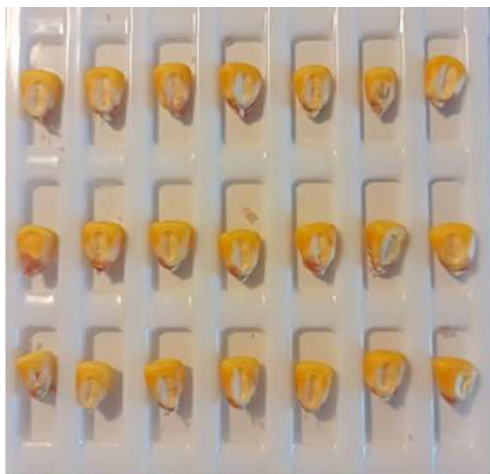
б - дополнительно изготовленная ячеистая кассета для загрузки зерна кукурузы в диафаноскоп
