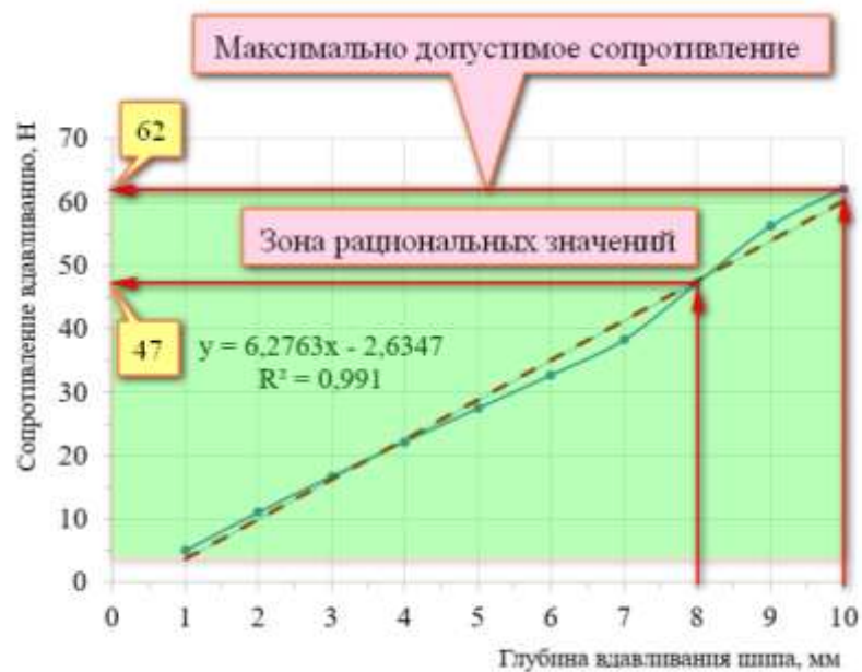
Рисунок 5.1 - Графическая зависимость сопротивления вдавливанию шипа в резиновую подошву пневмоподушки толщиной 3 мм от глубины его вдавливания, при условии внутреннего избыточного давления 0,4 атмосферы
