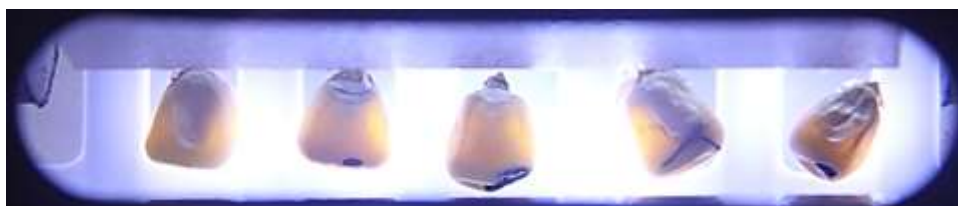
Рисунок 5.8 – Поврежденное зерно кукурузы в просвете диафаноскопа
