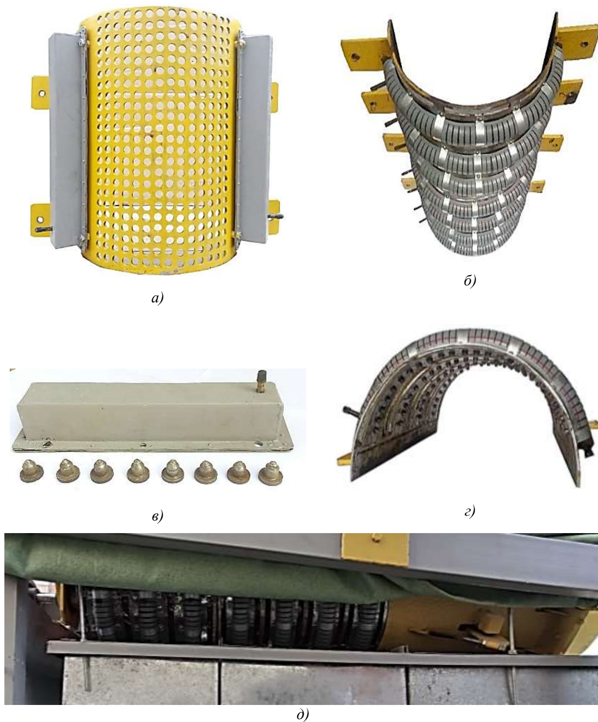
a – участок деки с продольными пневмоподушками; б – участок деки с поперечными пневмоподушками; в – продольная пневмоподушка с шипами в разобранном состоянии; г – шипованная поверхность участка деки с поперечными пневмоподушками; д – дека с поперечными пневмоподушками, установленная в нижней части МСУ Рисунок 4.4 – Изучаемые варианты конструкции пневмоадаптивной деки МСУ
