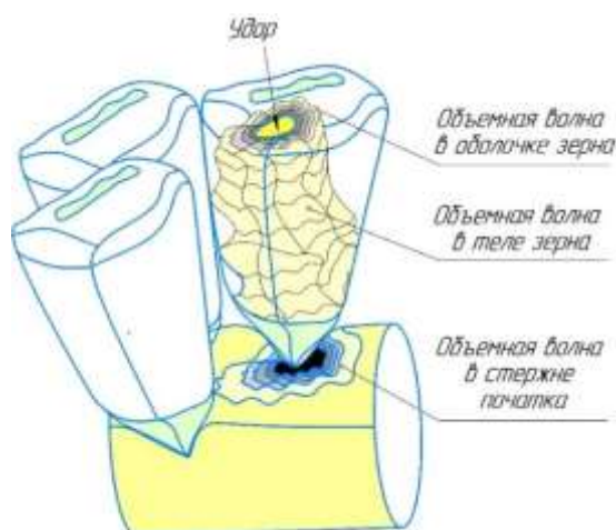
Рисунок 3.36 – Распространение ударной волны в теле зерна
