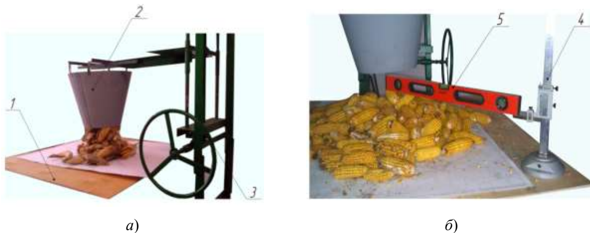
a – механизм подъёма конусного бункера; б – измерительные приборы; 1 – платформа; 2 – конусный бункер; 3 – подъёмник; 4 – штангенрейсмас; 5 – ватерпас Рисунок 2.4 – Установка для определения угла естественного откоса початков и стержней кукурузы
