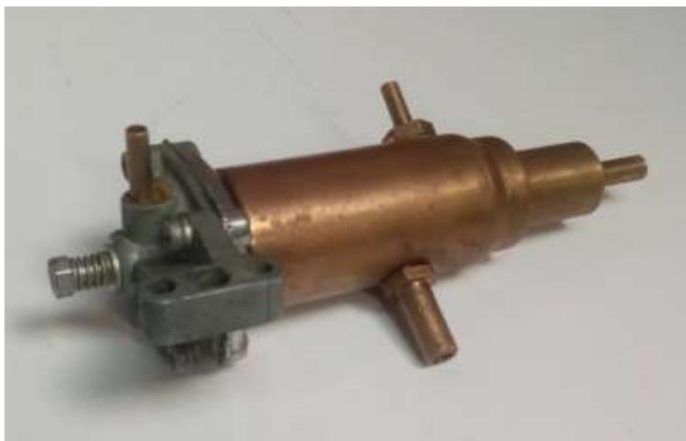
Рисунок 4.15 – Внешний вид дозатора-смесителя
