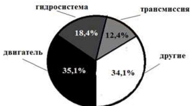
Рисунок 1.2 – Статистика отказов в работе тракторов в условиях реальной эксплуатации
