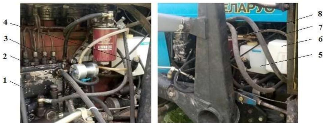
1 – топливный насос высокого давления, 2, 7 – топливные шланги,
