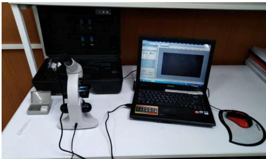
Рисунок 4.8 – Внешний вид цифрового микроскопа с ПЭВМ
