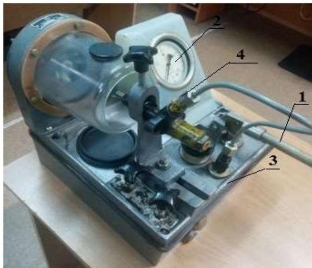
1 – ручной насос; 2 – манометр; 3 – ёмкость для топлива; 4 – соединительная муфта
