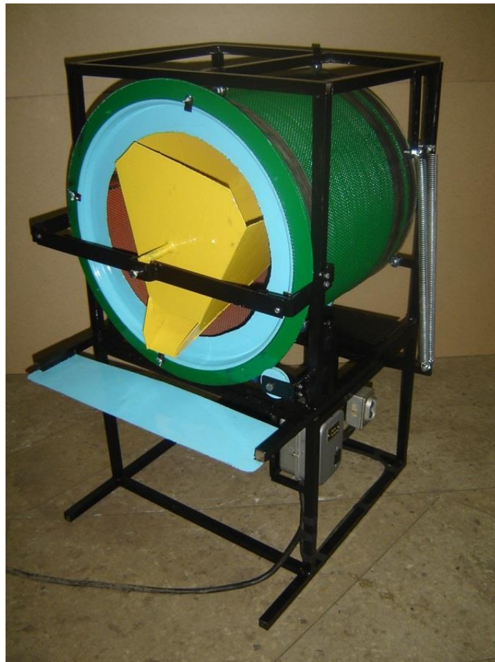
Рисунок 3.25 – Общий вид станда для исследований ячеистых поверхностей
