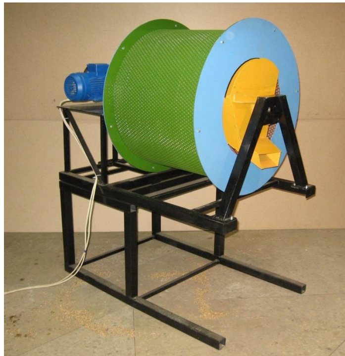
Рисунок 3.19 – Общий вид станда для исследований ячеистых поверхностей
