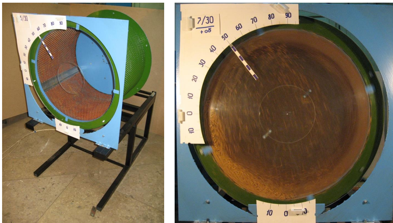
Рисунок 4.1 – Стенд для исследований геометрических параметров сегмента
