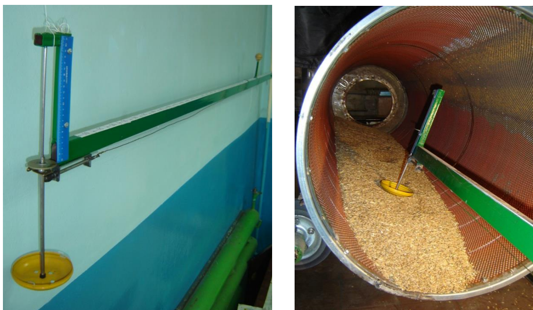
Рисунок 3.14 – Общий вид прибора для измерения толщины слоя сыпучих материалов в технологических емкостях
