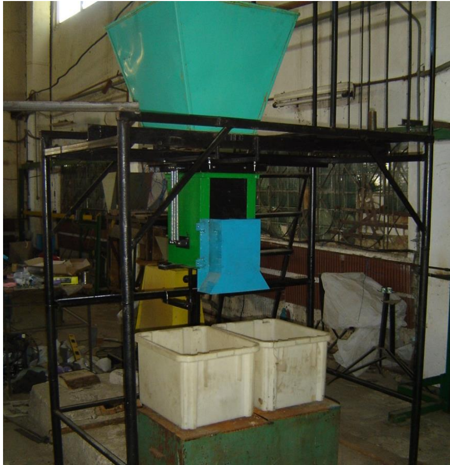
Рисунок 3.31 – Общий вид экспериментального делителя с грузовоспринимающей системой и шиберным отводом
