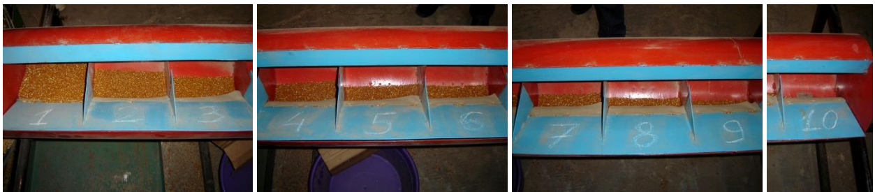
Рисунок 4.38 – Распределение выделенной примеси по длине ячеистой поверхности
