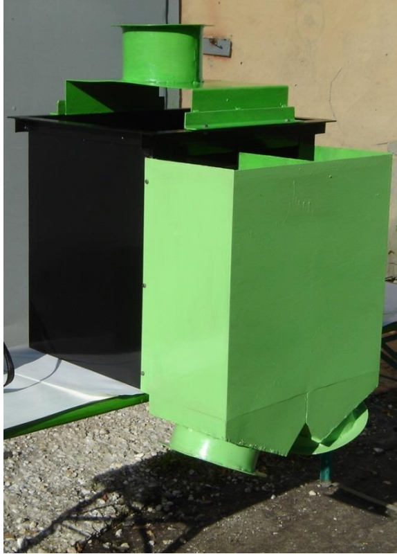
Рисунок 4.80 – Общий вид делителя потока, пропускной способностью до 50 т/ч.
