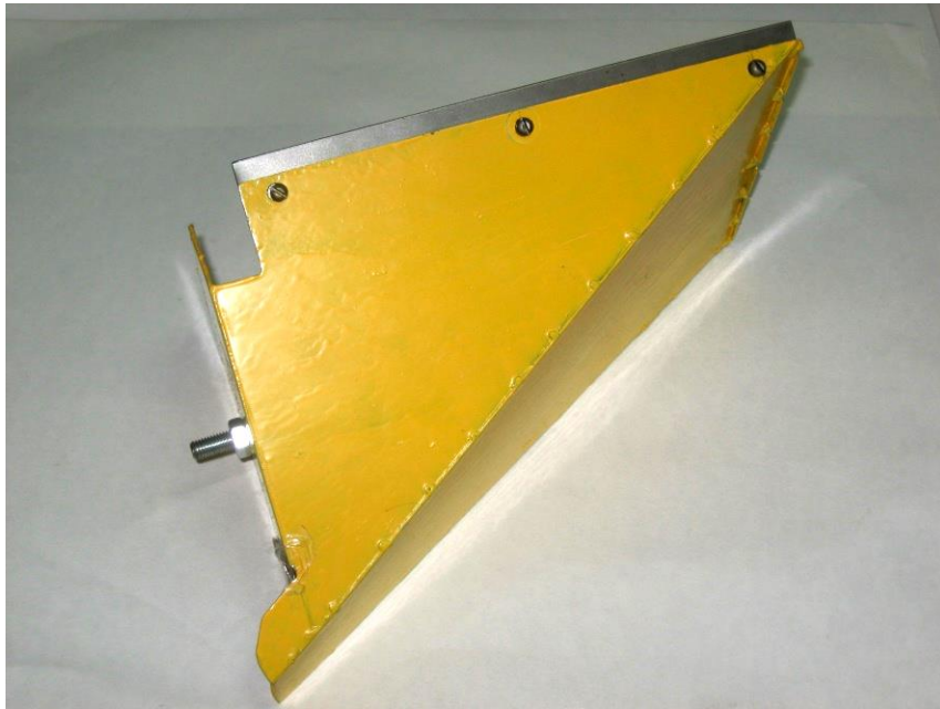
Рисунок 4.48 – Наращивание передней стенки приемного лотка с помощью металлической пластины
