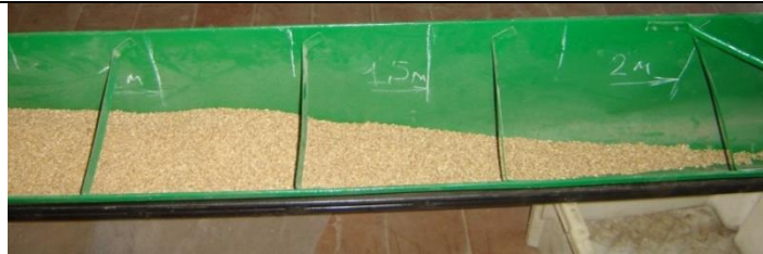
Рисунок 4.20 – Распределение выделяемого зерна пшеницы по длине цилиндра при W = 2563 кг/ч и n = 40 об/мин.
