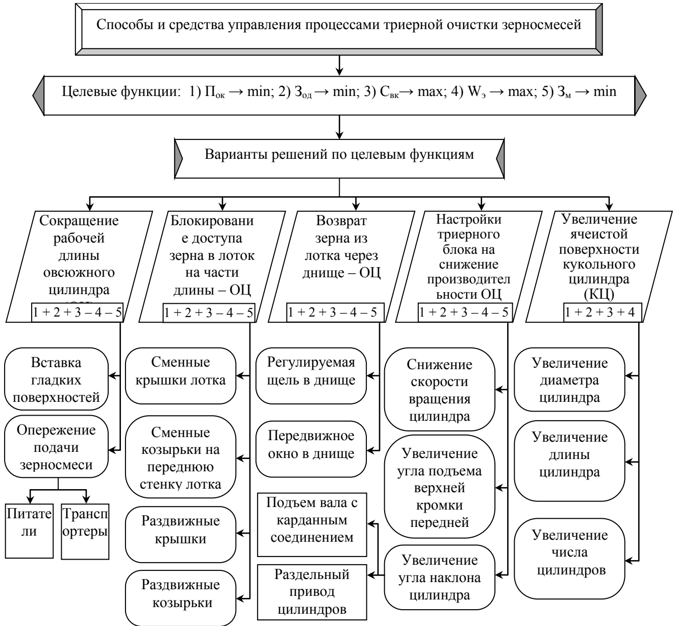
Рисунок 2.2 – Способы и средства управления процессами триерной очистки зерносмесей
