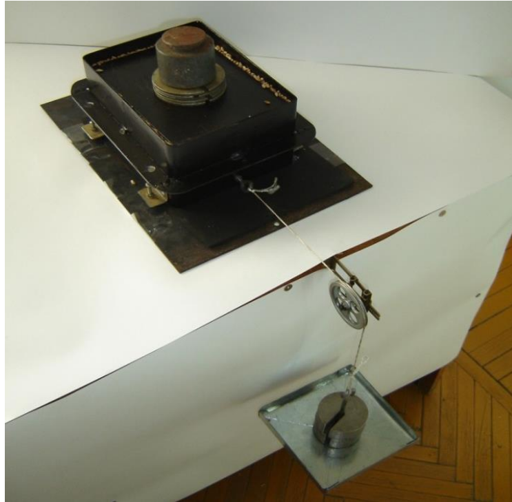
Рисунок 3.13 – Прибор для определения коэффициента силы трения покоя, исключающий неопределенность (погрешность) контакта короба с поверхностью
