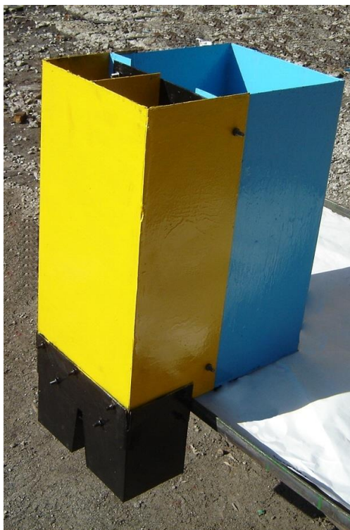
Рисунок 3.29 – Общий вид экспериментального делителя потока зерна жалюзийного типа
