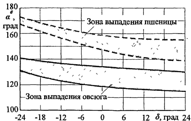
Рисунок 1.16 – Параметры выпадения частиц из ячеек в зависимости от угла \delta наклона задней стенки ячейки: n = 42 об/мин; f = 0,2 ; d_{я} = 9 мм; h_{я} = 3,9 мм
