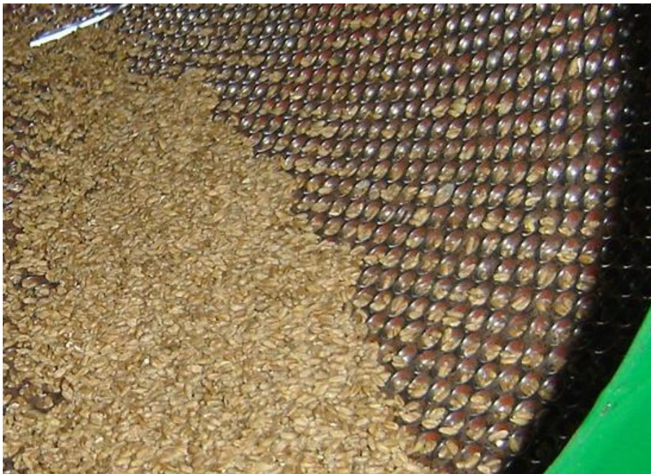
Рисунок 4.21 – Расположение зерновок пшеницы в ячейках овсюжного цилиндра.
