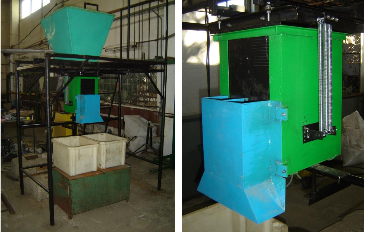
Рисунок 4.83 – Общие виды экспериментальной установки для исследования процесса разделения потока зерна
