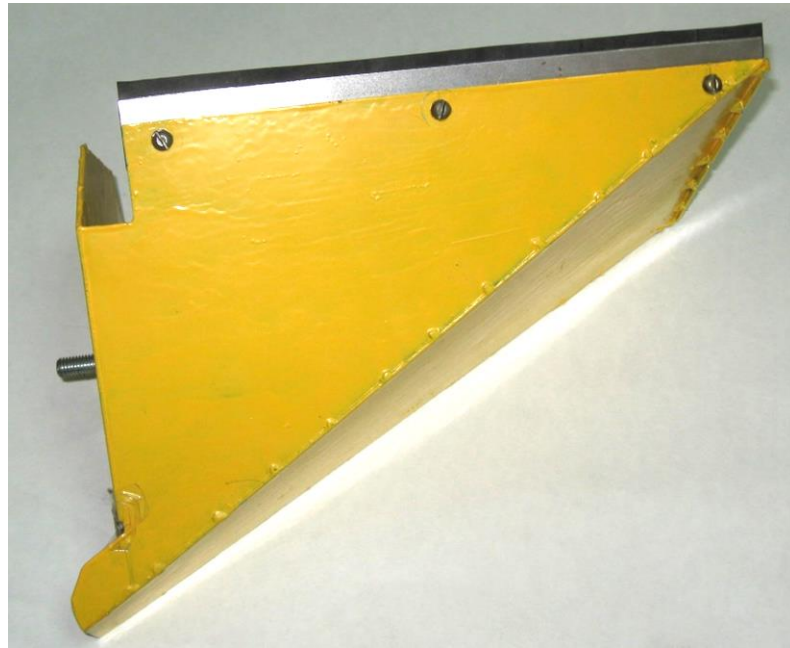
Рисунок 4.50 – Нарращивание передней стенки приемного лотка с помощью резиновой надставки
