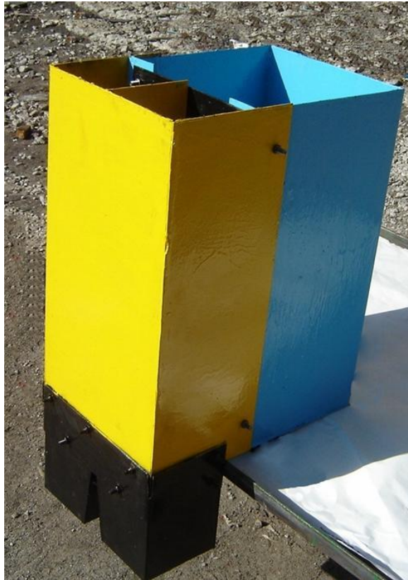
Рисунок 4.75 – Общий вид исследуемого делителя потока зерна.
