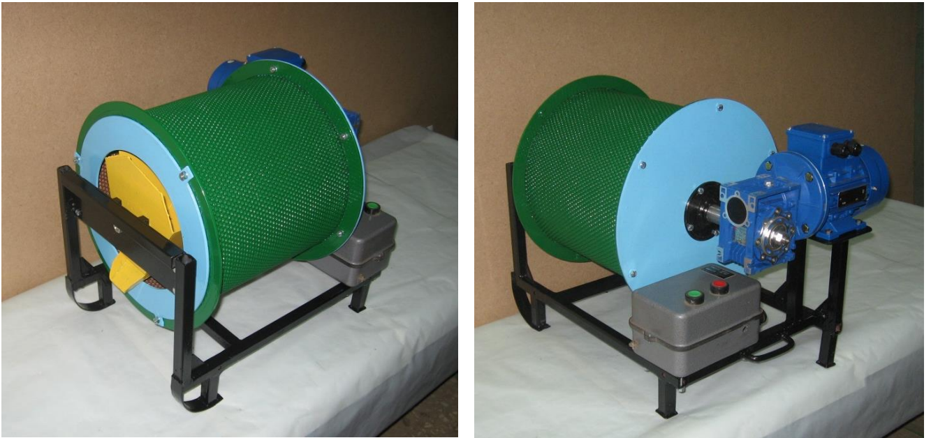
Рисунок 3.26 – Общий вид прибора для отсева проб зерносмесей
