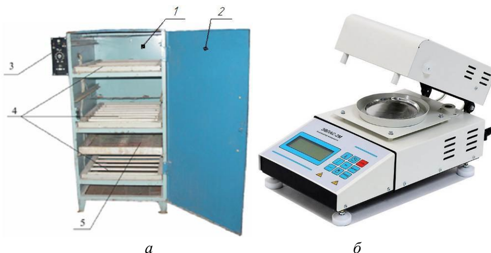
Рисунок 1. Стенд для исследований: а) сушильный шкаф: 1 – сушильная камера; 2 – дверка; 3 – пульт управления; 4 – инфракрасные нагреватели; 5 – лоток для продукта б) анализатор влажности «ЭВЛАС-2М»
