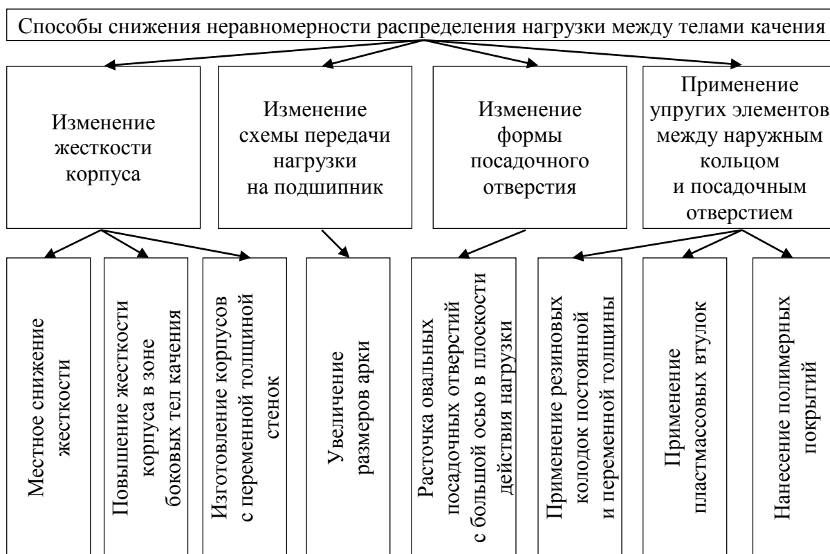
Рисунок 4. Классификация способов снижения неравномерности распределения нагрузки между телами качения [6]
