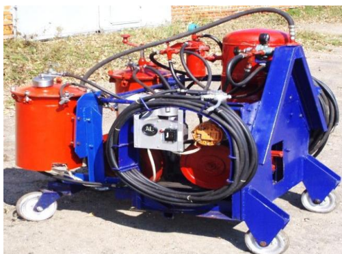
Рисунок 3. УЛН-03 – навесной агрегат для нанесения антикоррозийных покрытий
