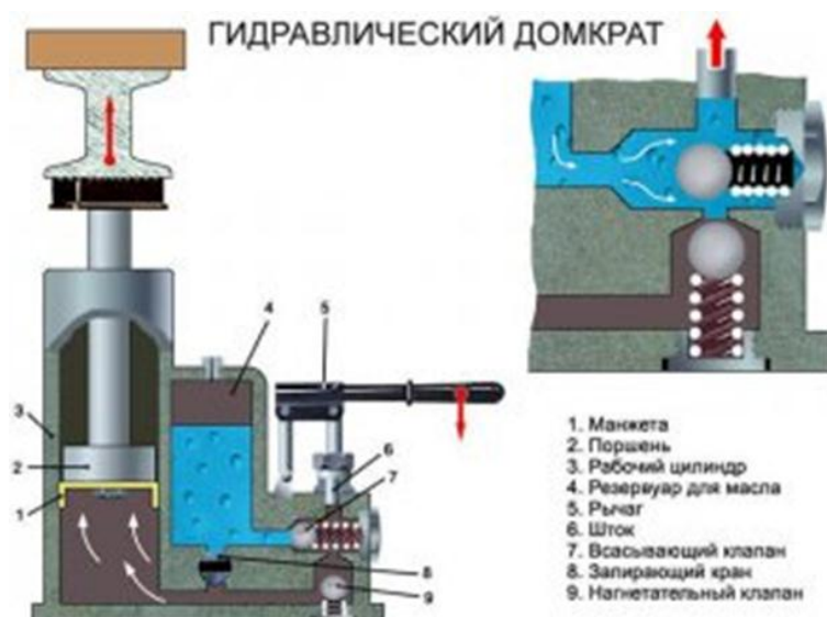
Рисунок 1. Схема конструкции и принципа работы гидравлического домкрата
