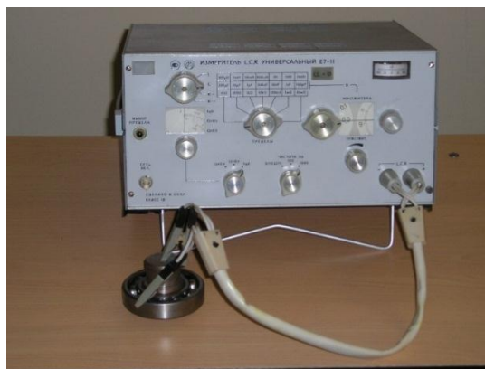
Рисунок 2. Исследование процесса полимеризации герметика АН-112 и композиции на его основе прибором Е7-11
