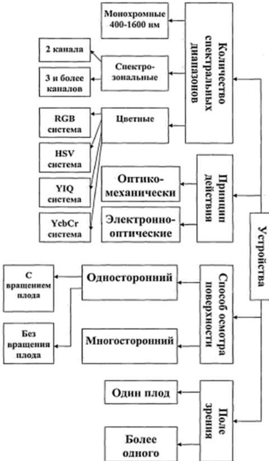
Рисунок 1.1 – Классификация устройств для распознавания качества плодов томатов.
