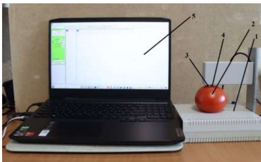
Рисунок 3.2 – Устройство для контроля степени зрелости томатов.
