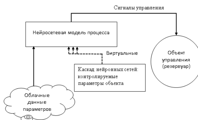
Рисунок 9 – Виртуально-облачная схема автоматизации объекта управления (резервуара) с применением нейронных сетей
