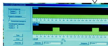
Гистограмма временных интервалов между импульсами, отображающих момент пролёта капсул через датчик.
