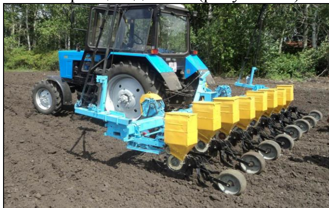
Рисунок 23. Экспериментальный образец сеялки для капсулированных семян
