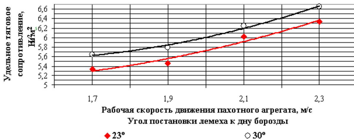
Рисунок 20. Изменение удельного тягового сопротивления поворотного плуга от скорости движения пахотного агрегата при различных углах постановки лемеха к дну борозды
