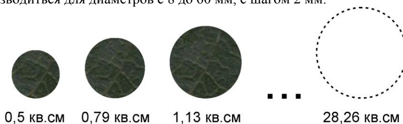
Рисунок 4. Круглые образцы площади разного диаметра
